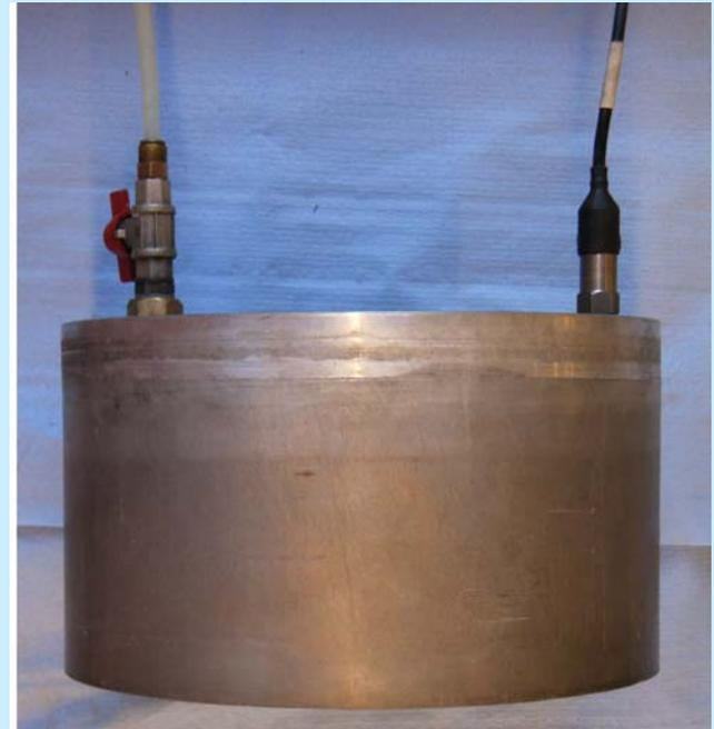
Modelo de una cámara a succión con válvula de fluido y transductor de presiones de poros
